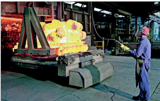
Die Gießerei Savimetal investiert laufend in die Optimierung ihrer Produktion. Das Bild zeigt die Wärmebehandlung von Stahlgussteilen. Foto: Savimetal
